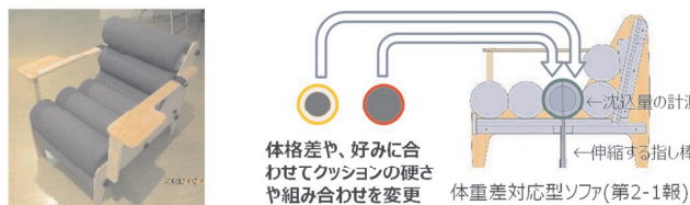
Fig. 12 利用者の体格差や好みに合わせて、クッションの組み合わせを変更可能な体重差対応型ソファ(伸縮する指し棒を取り付け、沈み込み変位量を計測)
