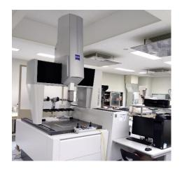
サブミクロンの測定精度を有し、これまでにない高精度なスキャニングや、レーザープローブによる非接触 3D 測定、3次元 CAD データ利用による高度な測定や解析が可能な三次元測定機です。最大800mmの長尺プローブで、多様なワーク対応します。
