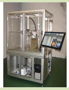
モータ固定子の鉄損分布を可視化することで、直感的にモー タ性能を表現できる装置を県内企業と共同開発しました(JST 大分県地域結集型研究開発プログラムの研究成果)。
