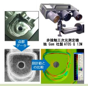
縞模様の光を測定物に照射することで、簡単・高速に測定物の表面形状を点群データとして得る事ができます。そのデータを用いて寸法測定や形状検査ができます。また、CADデータがあれば、実物との偏差をカラーマップで表示できます。
