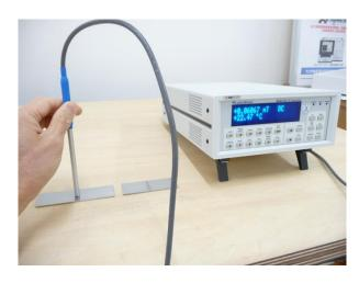
非磁性ステンレス鋼の加工に伴うマルテンサイト変態に起因する微小な磁化を測定しました。
