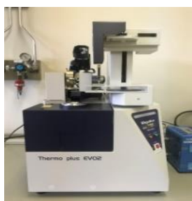
写真は導入した熱分析装置 Thermo plus EV02 シリーズ株式会社リガク (左から DSC、TMA、TG-DTA)
